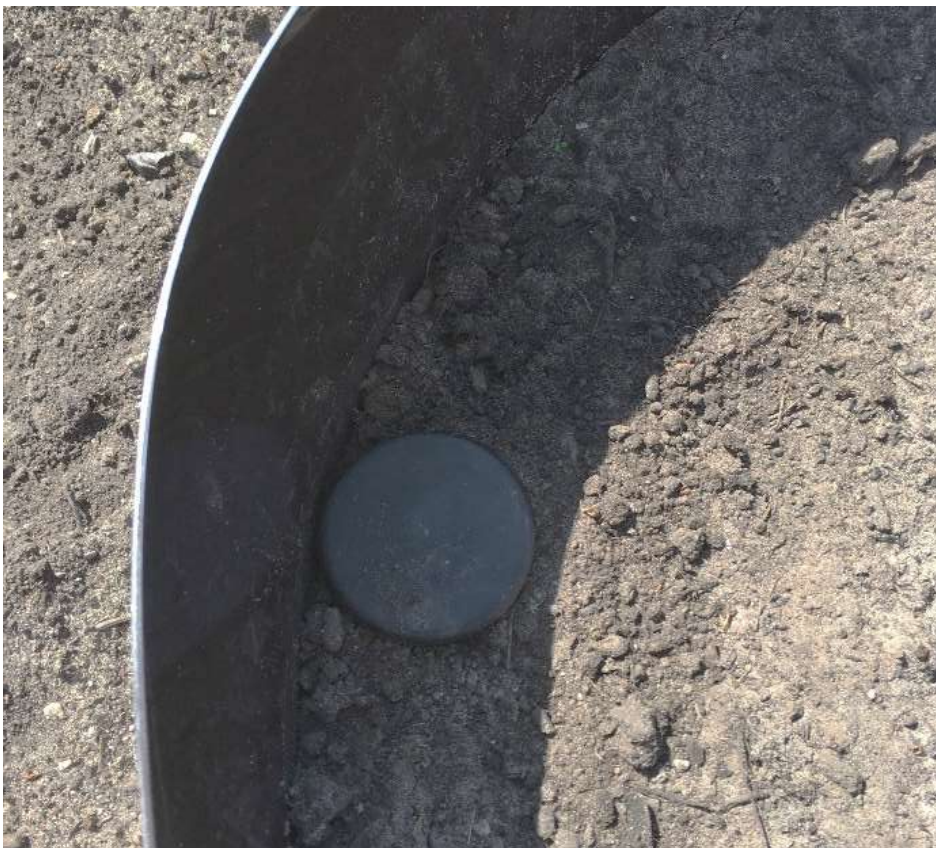
Een ConnectedGreen sensor vrijwel onzichtbaar weggewerkt in een gietrand
